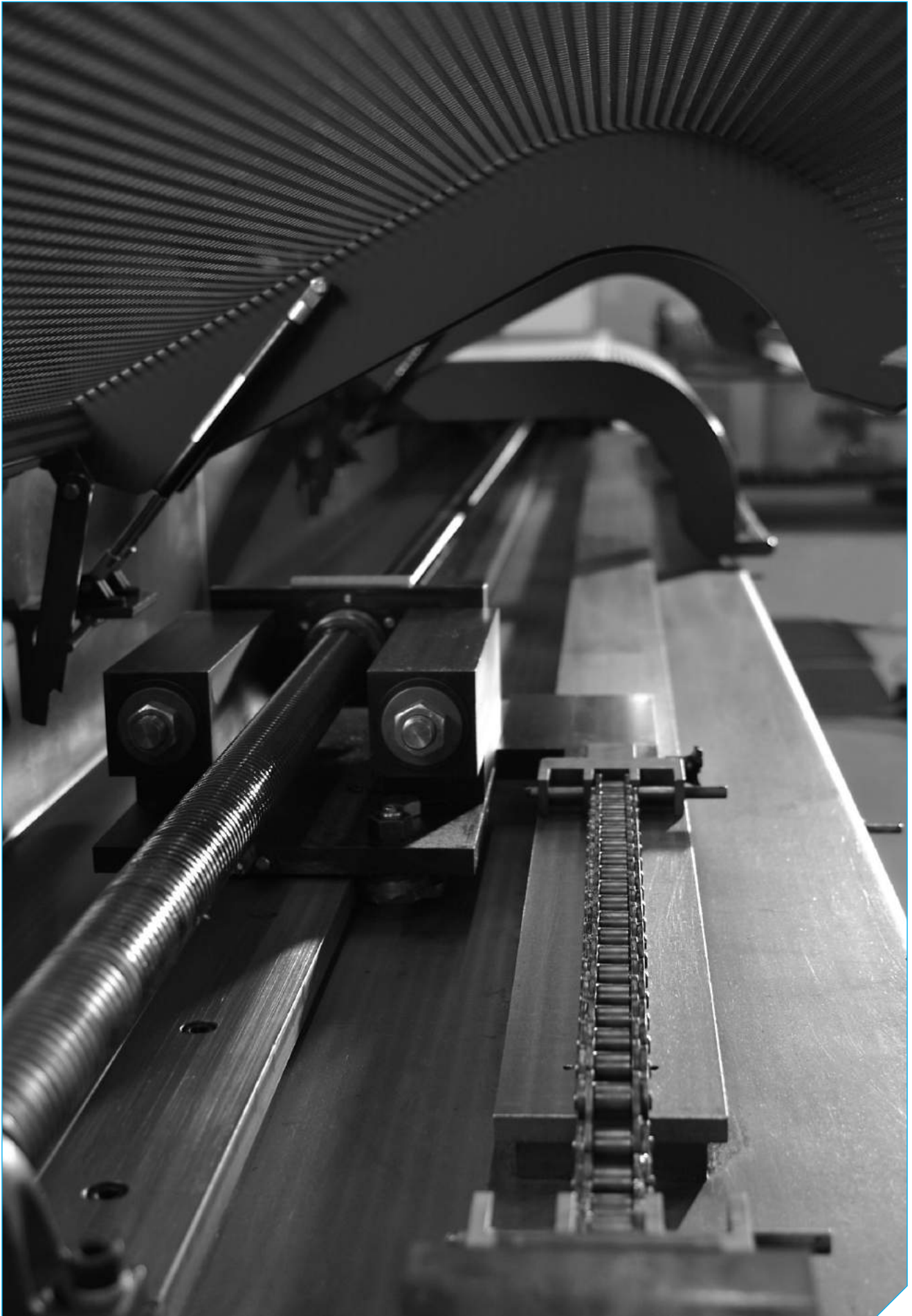
Matchy – Vorrichtung zum paarweisen Vorrecken für Parallellauf
