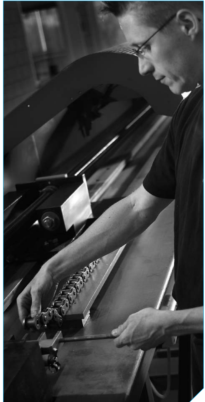
Abb. 29 Paarweises vorrecken für Parallellauf
